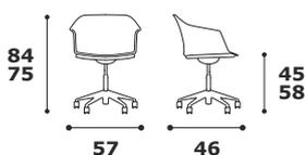
Versione con base girevole regolabile in altezza tramite pompa a gas cromata e base cinque razze in alluminio diametro mm 650, ruote con doppio battistrada diametro mm 65.
