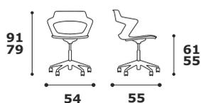
Versione con pompa a gas in acciaio cromato per la regolazione in altezza della seduta, base in alluminio pressofuso a 5 razze diametro mm 700 e doppie ruote diametro mm 65.
