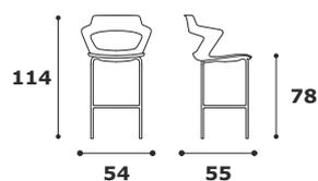
Sgabello fisso realizzato con telaio 4 gambe in acciaio cromato in tubo tondo diametro mm. 18.c
